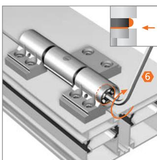
Hebespindel einschrauben, bis Lagerbuchse in Null-Stellung.
