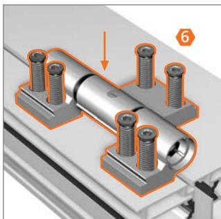
Bandkörper aufsetzen und durch mindestens zwei Profilwandungen von jeweils min. 1,6 mm verschrauben (20 Nm). Lieferzustand Nullstellung.
