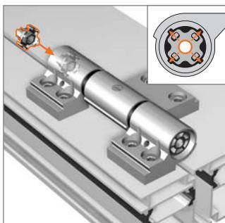
Verstellstern von oben in den Bandkörper einstecken, und Lagerbuchse damit nach unten verschieben.
